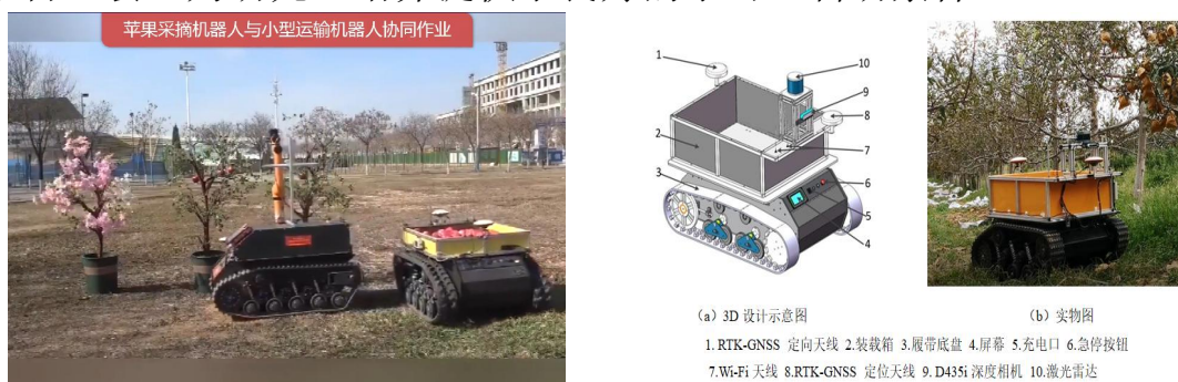
研发的苹果采摘机器人和运输机器人协同作业
